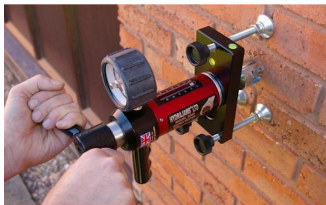
Рис.2. Испытание на вырыв анкерного дюбеля
